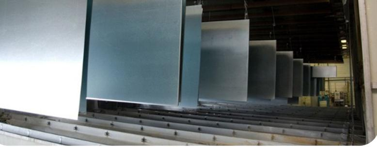
lung wenn es darum geht Rost, Walzhaut, Schweißrückstände etc. zu entfernen. Durch das Strahlen entsteht ein sauberer Untergrund der wiederum für eine gute Haftung sorgt. In Verbindung mit einer hochwertigen Beschichtung bietet diese Kombination einen jahrelangen Schutz z.B. Stahlfassadenelemente, Zargen, Türen und andere Konstruktionen
